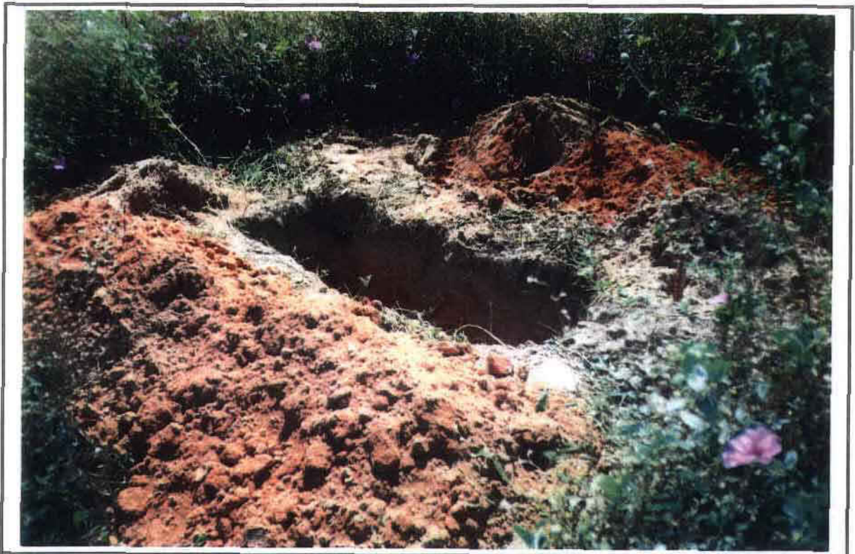
Foto 11 – Material fino para barragem, furo nº 02 da jazida nº 01.
